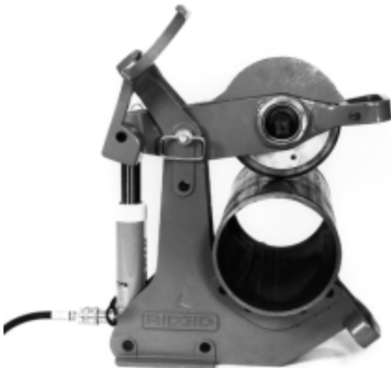
Figure 8 – Positionnement du tuyau sur la tronçonneuse
