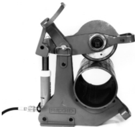
Figura 8 – Posición del tubo en el Cortatubos
