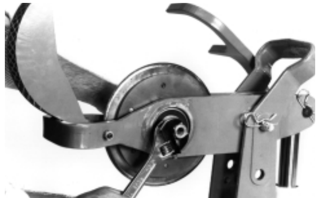
Figura 11 – Extraiga la tuerca de seguridad
